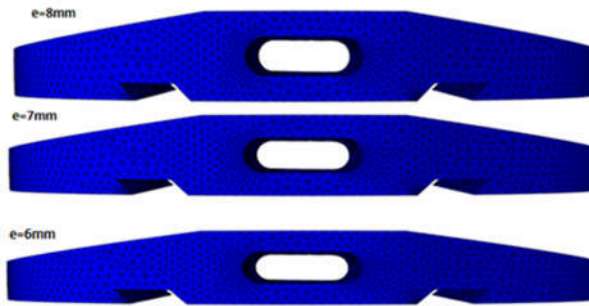
Fig. 6. Différentes épaisseurs étudiées du Polyéthylène.
